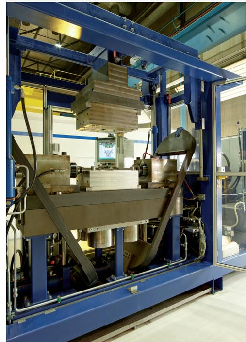
Abb. 30: Leichtbaupresse mit Carbonbügeln
