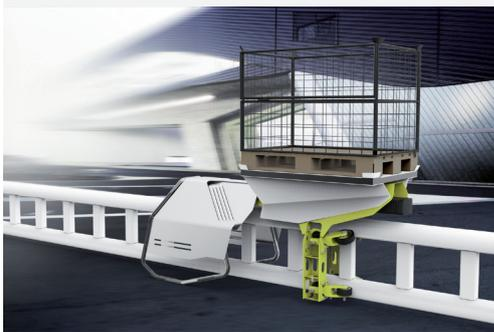
Abb. 21: Hochgeschwindigkeitsfördersystem mit Palettenträger
