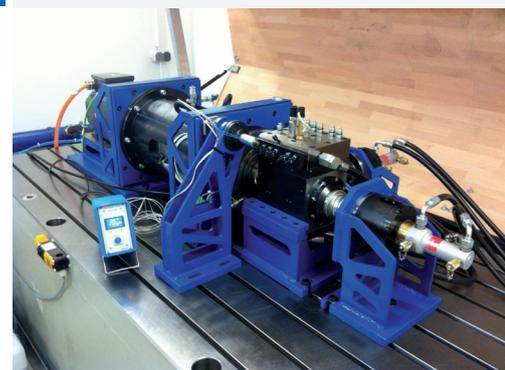
Abb. 19: Lasteinleitungseinheit komplett (Rotorprüfstand) gerendert und im Original
