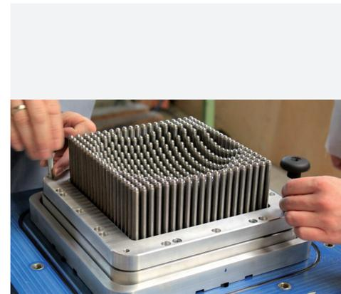
Abb. 19: Formspeicher, konfiguriert für die Abformung einer Kugelkalotte
