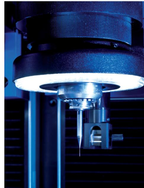
Abb. 35: Hochfrequenzspindel mit Werkzeug zur spanenden Mikrobearbeitung
