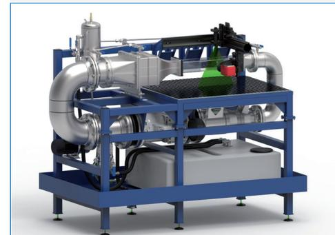
Abb. 15: Einsatz der Particle Image Velocimetry (PIV) am Wasserströmungskanal
