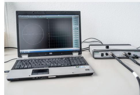
Abb. 10: Vektorieller Netzwerkanalysator mit Steuerungs- und Auswertesystem
