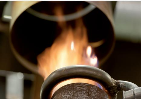
Abb. 17: Abgasfackel an einem Härteofen
