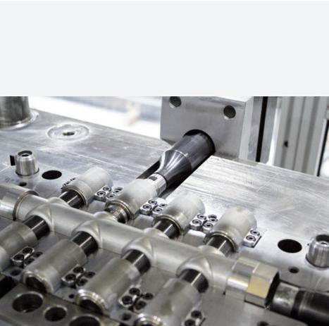
Abb. 30: Werkzeugsystem für das Formen und Fügen mittels IHU
