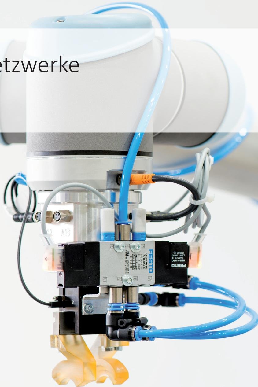
Leichtbauroboter mit Greifersystem
