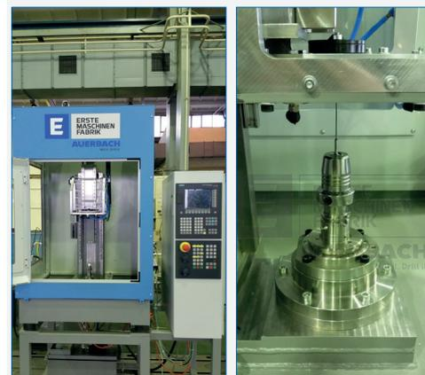
Abb. 27: ERMAFA-Mikrotiefbohr-Prüfstand inkl. Detail „Werkzeugaufnahme“
