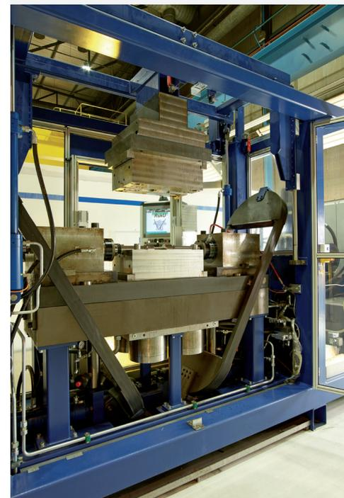
Abb. 31: Leichtbaupresse mit Carbon- bügeln
