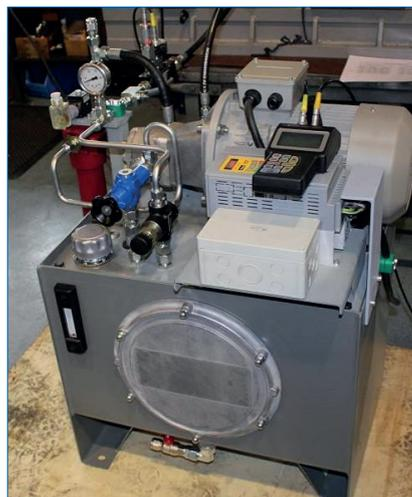
Abb. 26: Hochdruck-Kühl-Schmierstoff-System als Demonstrator und CAD-Modell
