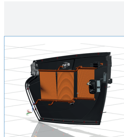
Abb. 14: Türinnenverkleidung mit textilen Wärmetauschern
