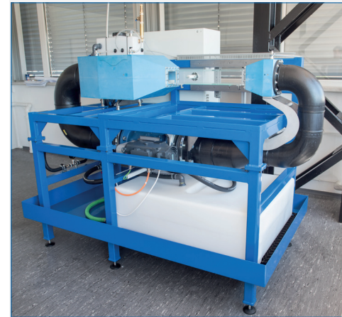
Abb. 6: Radiallagerprüfstand mit Strömungskanal
