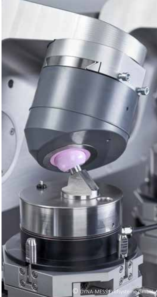
Abb. 28: Darstellung einer einzelnen Prüfkammer für das Hüftgelenkimplantat
