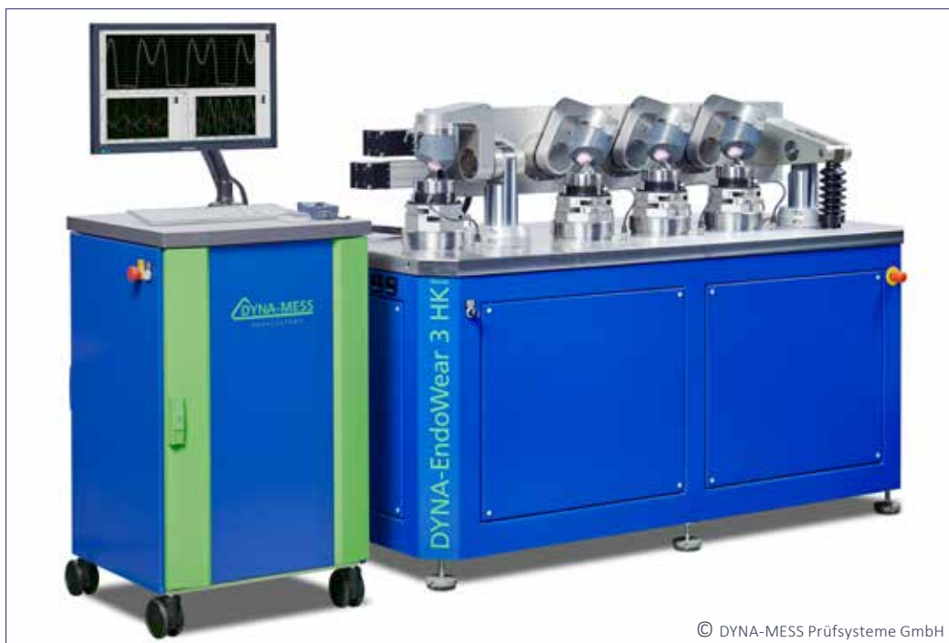
Abb. 29: Gesamtansicht des Verschleißsimulators EndoWear 3 HK
