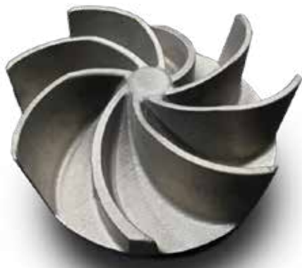
Abb. 44: Gussteil aus einer Niederdruckgießanlage
