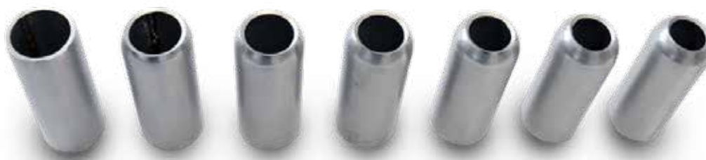
Abb. 32: Verformung von angestauchten Hülsen im Endbereich bei verschiedenen Stauchkräften (von links nach rechts; Krafteinwirkung bei: 20 kN, 40 kN, 55 kN, 65 kN, 75 kN, 85 kN, 95 kN)
