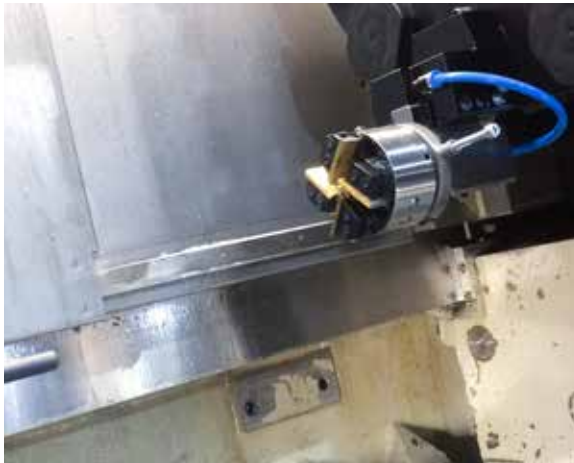
Abb. 54: Am Werkzeugrevolver befestigter Gewindeschneidkopf (links: Gesamtansicht, rechts: Detaillansicht)
