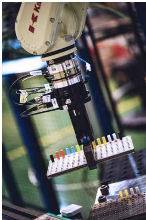
Abb. 14: Detailsicht Positionierung des Greifers mit Steckplatte
