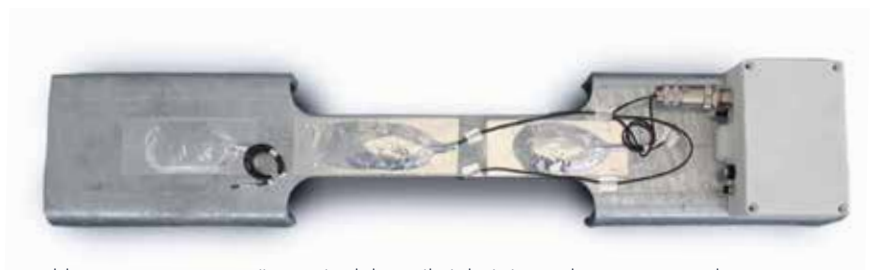
Abb. 23: DMS Sensorträger mit Elektronikeinheit im verbauten Zustand
