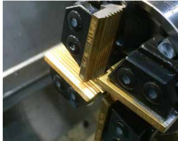
Abb. 54: Am Werkzeugrevolver befestigter Gewindeschneidkopf (links: Gesamtansicht, rechts: Detaillansicht)
