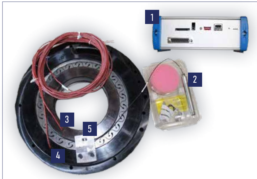
Abb. 8: Vorspannmodul mit Hublagen- und Temperaturmesstechnik; Steuer- und Regelungsmodul
