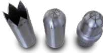
Abb. 30: Schließung einer Hülse mittels IHU-Pressen im Preprozess mit innerem Formstempel
