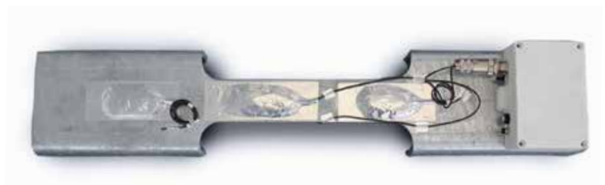
Abb. 23: DMS Sensorträger mit Elektronikeinheit im verbauten Zustand
