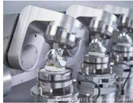
Abb. 27: Verschleißstationen des entwickelten Verschleißsimulators: Verschleißstation mit Kniegelenkimplantat
