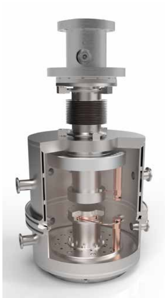
Abb. 18: Prozessdruckkammer mit Werkzeugsystem und thermischer Entkopplung
