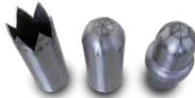
Abb. 30: Schließung einer Hülse mittels IHU-Pressen im Preprozess mit innerem Formstempel
