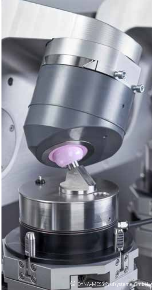
Abb. 28: Darstellung einer einzelnen Prüfkammer für das Hüftgelenkimplantat
