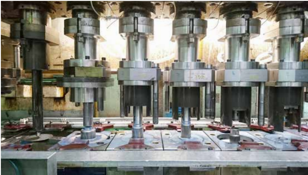
Abb. 36: Kippeln der Halbzeuge beim Beschneiden und Fertigziehen im Tiefziehprozess mit der Stufenpresse
