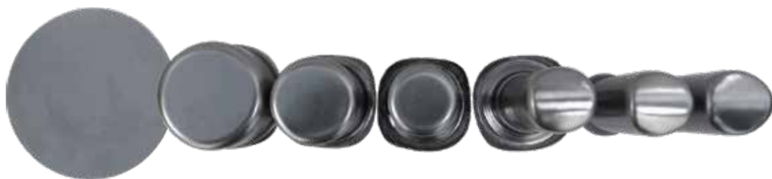
Abb. 35: Phasen beim Fertigziehen in der Stufenpresse (links Ausgangszustand, rechts fertiges Tiefziehteil)
