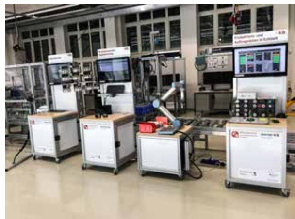
Abb. 52: Auswahl verschiedener „Industrie 4.0“ Demonstratoren in der Experimentier- und Digitalfabrik der TU Chemnitz
