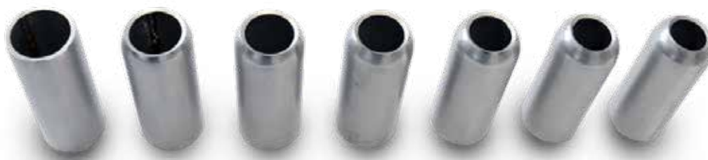
Abb. 32: Verformung von angestauchten Hülsen im Endbereich bei verschiedenen Stauchkräften (von links nach rechts; Kräfteinwirkung bei: 20 kN, 40 kN, 55 kN, 65 kN, 75 kN, 85 kN, 95 kN)
