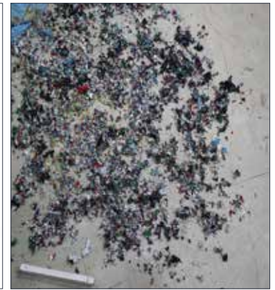
Abb. 36: Beispiel ordnungsgemäß zerkleinertes Schreddergut
