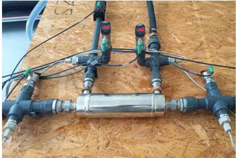
Abb. 23: Fertig entwickelter Wärmeübertrager auf dem Prüfstand zur Leistungsvermessung inkl. angeschlossener Temperatur- und Durchflusssensoren
