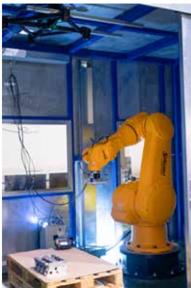
Abb. 7: Erweiterung Technologiezelle zur Ermittlung verfahrensspezifischer Kennwerte
