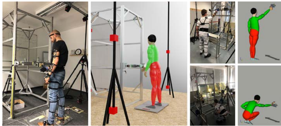
Abb. 35: Versuchsaufbauten zur Vermessung manuelle Kraftaufbringungen: links Versuchsreihe im Labor, rechts Versuchsreihe bei assoziierten Partnern
