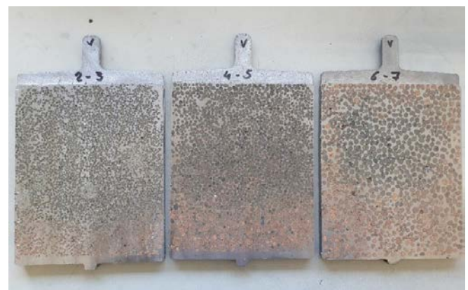
Abb. 23: Gegossene und vollständig infiltrierte Batterieelektrode aus unterschiedlichen Granulatgrößen
