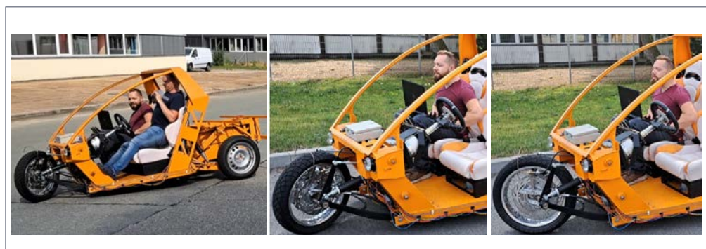
Abb. 18: Fahrversuche ferngesteuertes Fahren, Fernsteuerung der Lenkung im Stand
