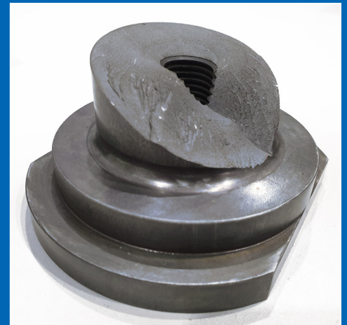
Abbildung 1: Bruchfläche an einem Umformwerkzeug
