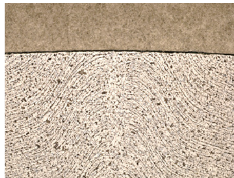
Abbildung 2: Gefügeuntersuchung an einer innenhochdruckgefühten Pressverbindung
