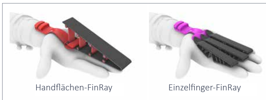
Abb. 27: FinRay-Elemente für die gesamte Handfläche oder für Einzelfinger
