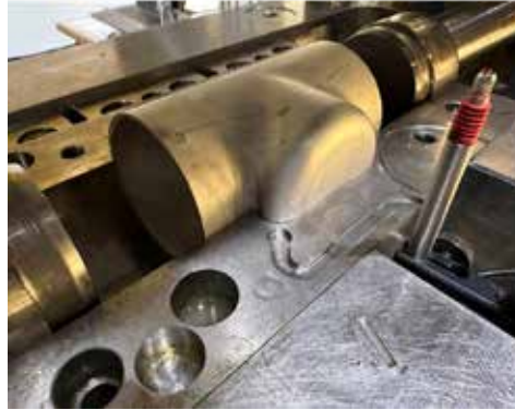
Abb. 49: Bauteil im Werkzeug eingelegt
