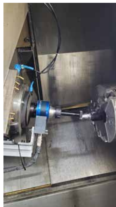
Abb. 26: Schwingungs- und Zerspankraftmessungen beim Wälzschälen
