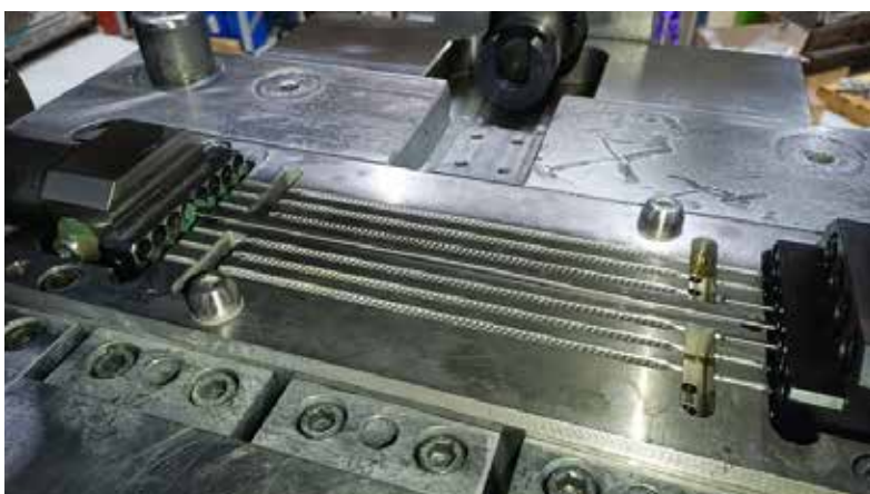
Abb. 6: Unverformtes Halbzeug in Zentralkontur des Mehrfachwerkzeugs am ICM e.V.
