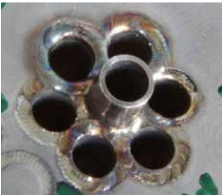
Abb. 8 Erfolgreiche Schweißversuche ohne Zusatzwerkstoff selbst bei Spalten bis 0,2mm
