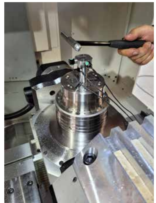
Abb. 24: Experimentelle Modalanalyse an einer Werkzeugaufnahme
