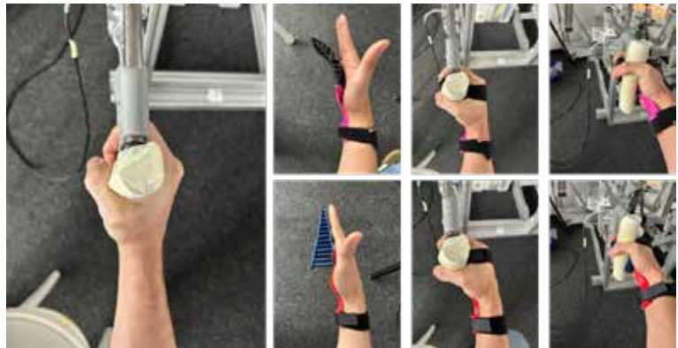
Abb. 28: Versuchsstand zur Beanspruchungsmessung: links – Referenzmessung ohne Unterstützung, oben – Einzelfinger-FinRay, unten – Handflächen-FinRay
