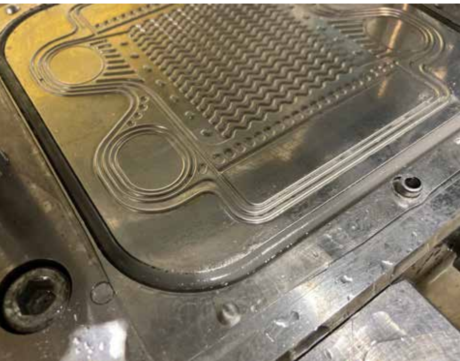
Abb. 18: Doppelnutzung der Dichtung
