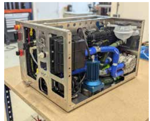
Abb. 16: Entwickeltes 5 kW Brennstoffzellensystem mit Effizienzmodul
