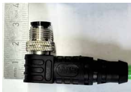
Abb. 8: Miniaturisierter, 360° geschirmter und 90° abgewinkelter Steckverbinder
