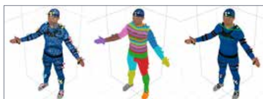
Abb. 56: Automatisierter Auswertungsprozess von links nach rechts: Markerclustererkennung, Segmentierung und Erkennung von Leitmaßen.
