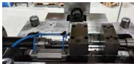
Abb. 7: Im Vorhaben umgesetztes IHU-Werkzeug
