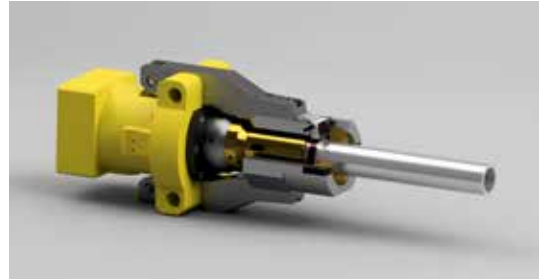
Abb. 18: Sensorlösung zur Drehzahlmessung für den Forschungspartner
