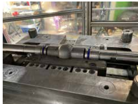
Abb.46: Halbzeug eingelegt in IHU-Werkzeug
