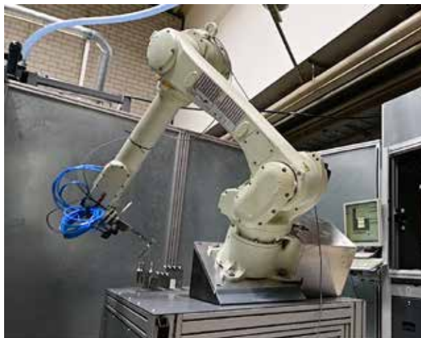
Abb. 39: Übergabe des fertig gelaserten Bauteiles auf den Werkstückträger [Fa. SITEC]
