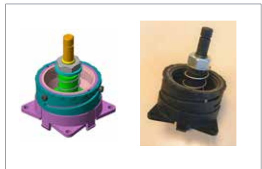
Abb. 52: Konzept und Umsetzung der Joystickmechanik mit manueller Verstellung von Betätigungskraft und Bewegungsradius
